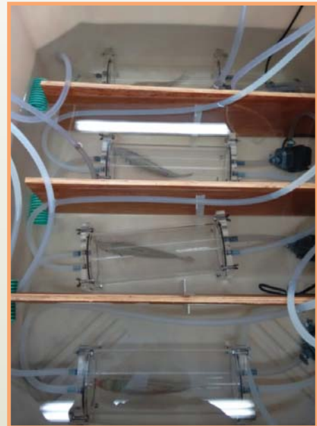
Εικόνα 4. Σύστημα προσδιορισμού του μεταβολικού ρυθμού ψαριών σε επίπεδο ατόμων.
