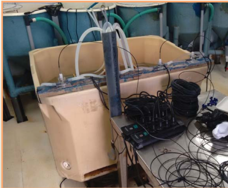
Εικόνα 4. Σύστημα προσδιορισμού του μεταβολικού ρυθμού ψαριών σε επίπεδο ατόμων.
